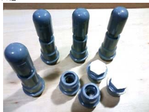
図-8 塩ビの水道管を使ったアジャスター金具
