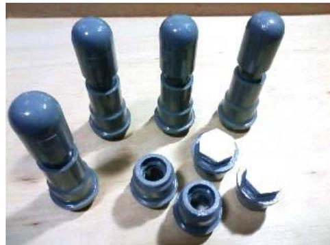
図-6 塩ビの水道管を使ったアジャスター金具
